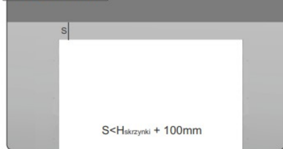
9a. Jeśli wysokość S jest mniejsza niż H skrzynki + 100mm wówczas należy montować skrzynkę bramy nałożoną na przewodnice (w zestawie).
