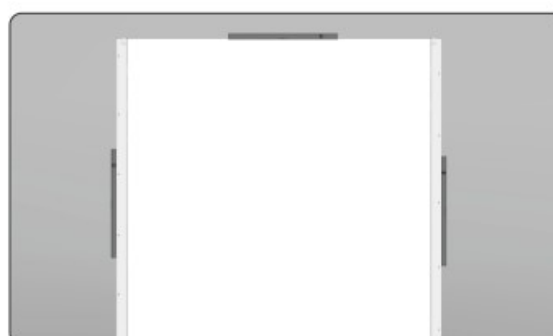
6. Przyłożyć prowadnice do podłoża i za pomocą poziomic ustawić w pionie oraz względem siebie równoległe.
