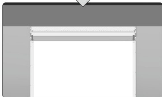
11. Nasunąć skrzynkę na przykręcone przewodnice.
